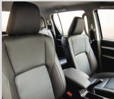
Butacas delanteras con función de ventilación
