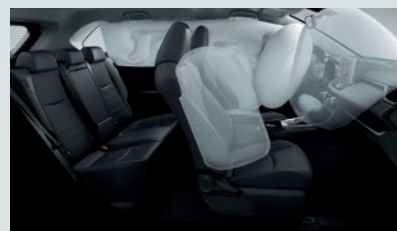
AIRBAGS FRONTALES (X2), LATERALES (X2), DE CORTINA (X2) PARA EL CONDUCTOR Y PASAJERO, Y DE RODILLA (X1) PARA EL CONDUCTOR.
